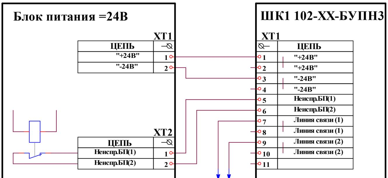
Если внешний источник питания =24В не формирует извещение "Неисправность", то для избежания передачи на ЦП извещения "Неисправность БП" на контакты 5 – 6 разъёма ХТ1 шкафа ШК1 102-XX-БУПНЗ необходимо установить перемычку.
