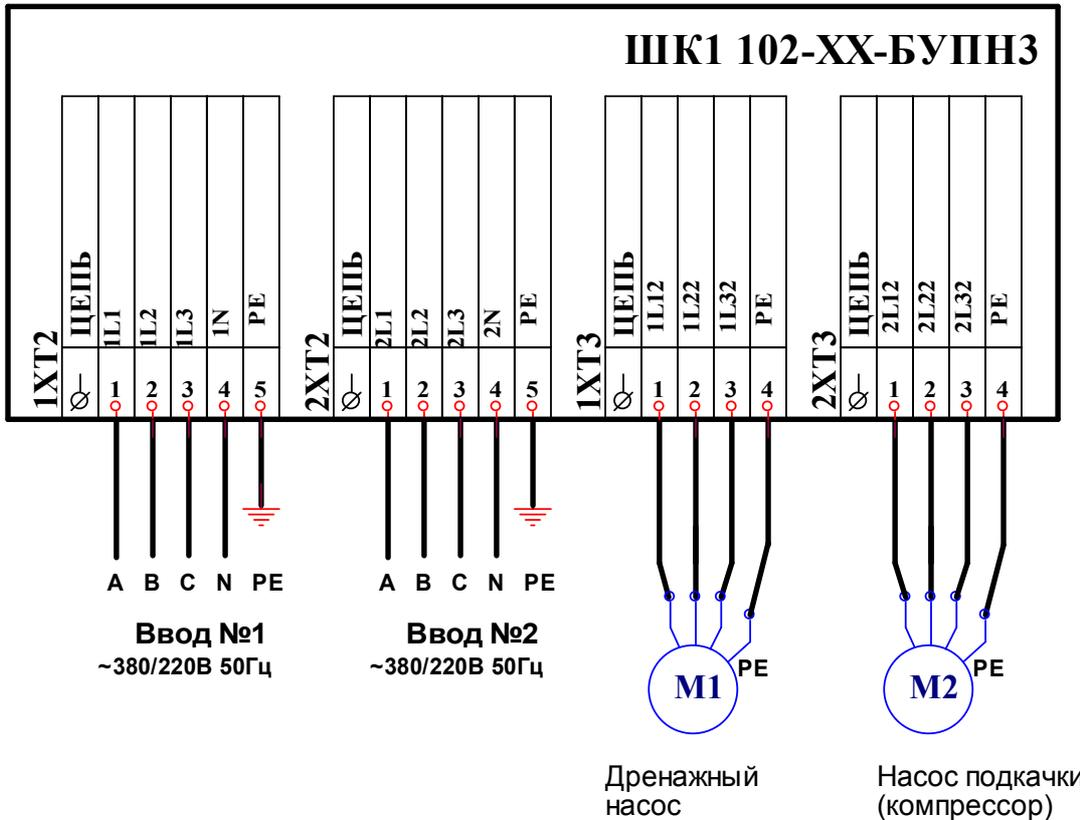
Схема подключения блока питания и линии связи:
